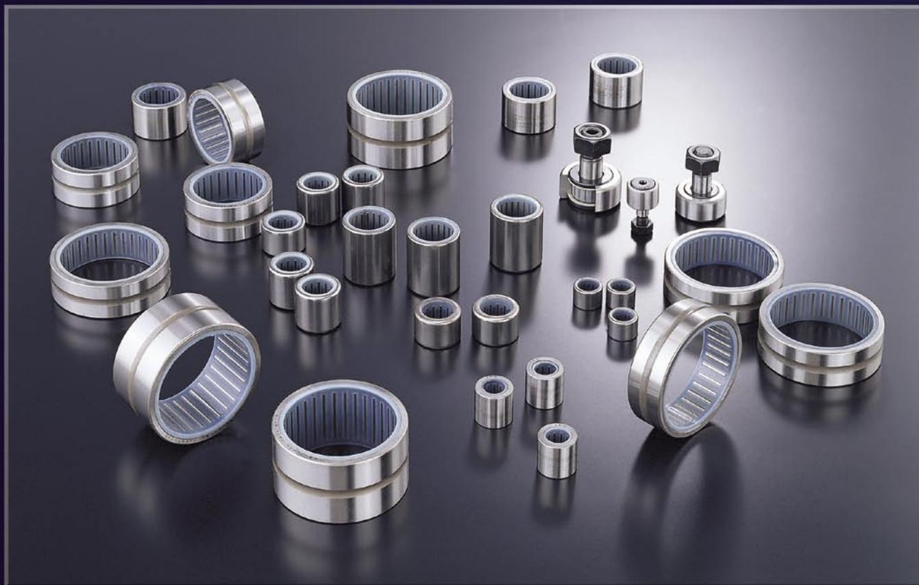
Подшипники Carilube производства компании **IKO** содержат предварительно заложенную в них термореактивную смазку твердого типа (Carilube). При вращении подшипника достаточное количество смазочного масла просачивается на поверхность качения, поддерживая смазочную способность в течение гораздо более длительного времени. Опорные ролики с цапфой и игольчатые роликовые подшипники машинной обработки также поставляются со смазкой Carilube.
